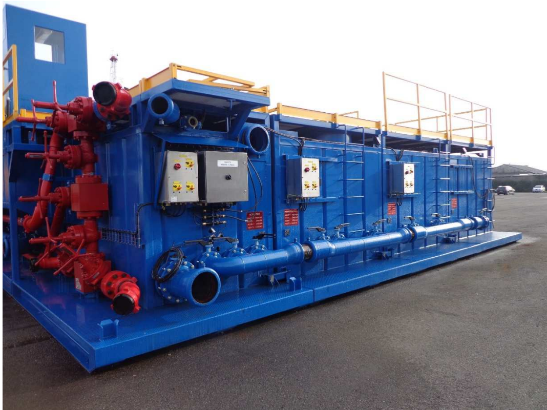
TUYAUTERIE HAUTE/BASSE PRESSION BACS A BOUES
