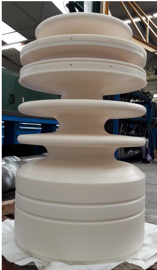
ISOLANT DE GENERATEUR EN PA-6 (Ø800-L1000 MM)
