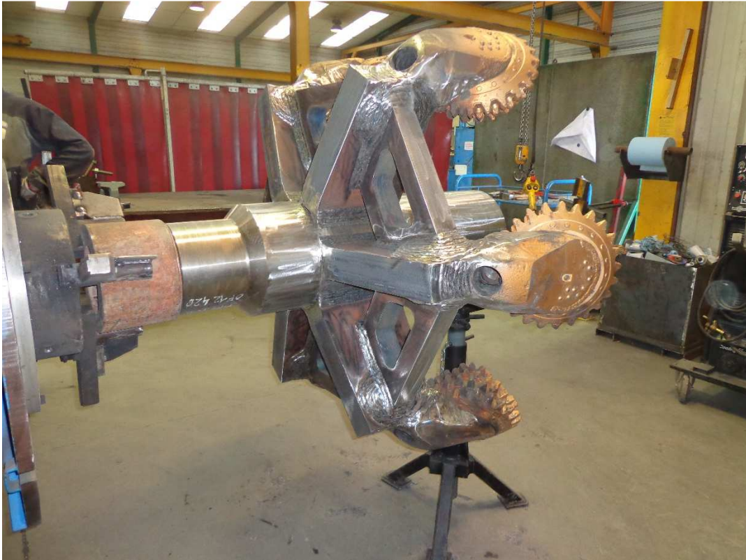
FABRICATION ALESEUR DE FORAGE 28"
