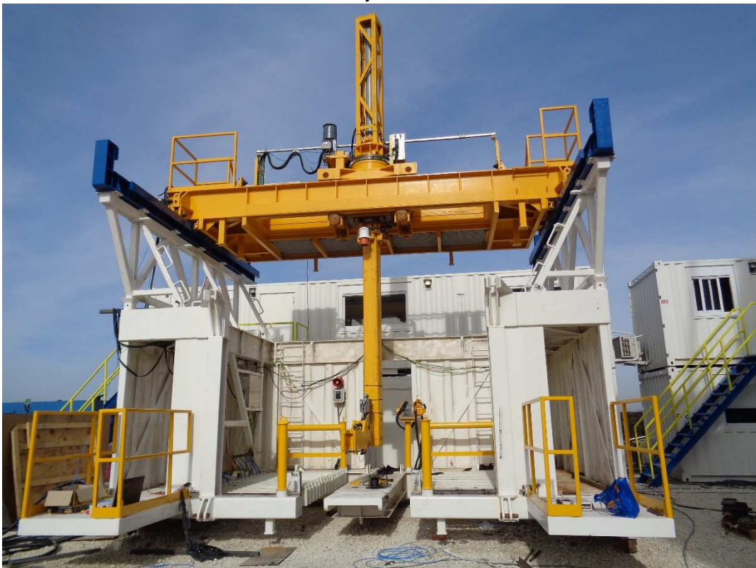
MONTAGE PIPE HANDLER (RACKEUR DE TIGES DE FORAGE)
