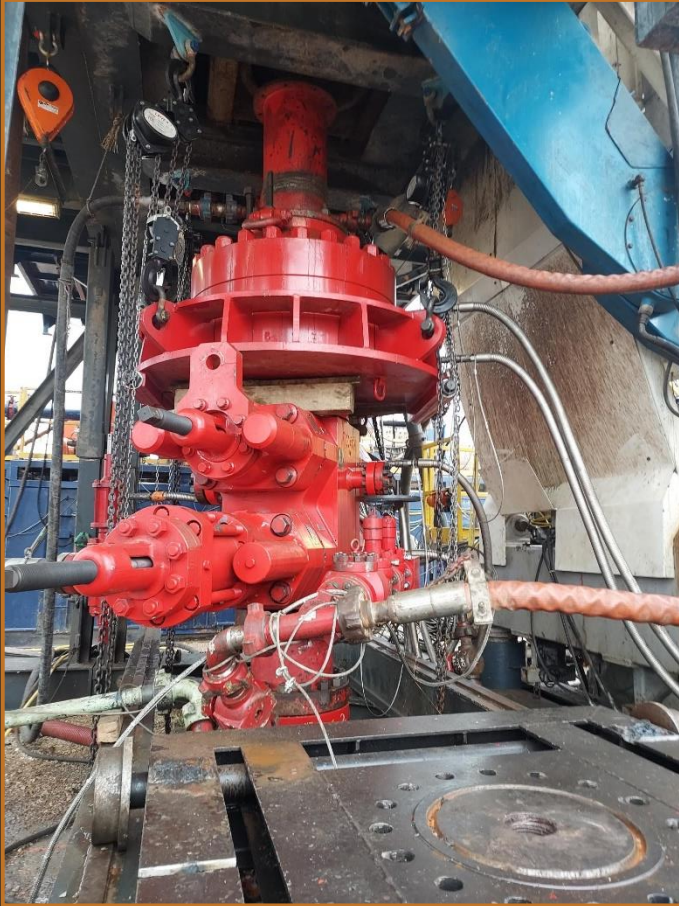
Fabrication collier de levage pour BOP13" 5 / 8 5000 Psi
