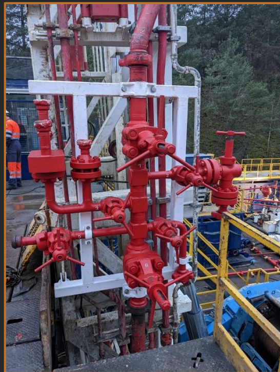
Equipement haute pression / Stand pipe Manifold (5000 Psi)
