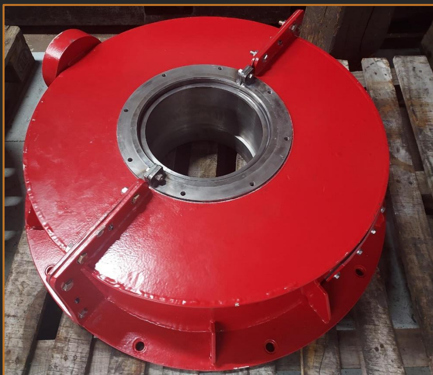
Bâche à huile (mécanosoudé reprise en usage)
