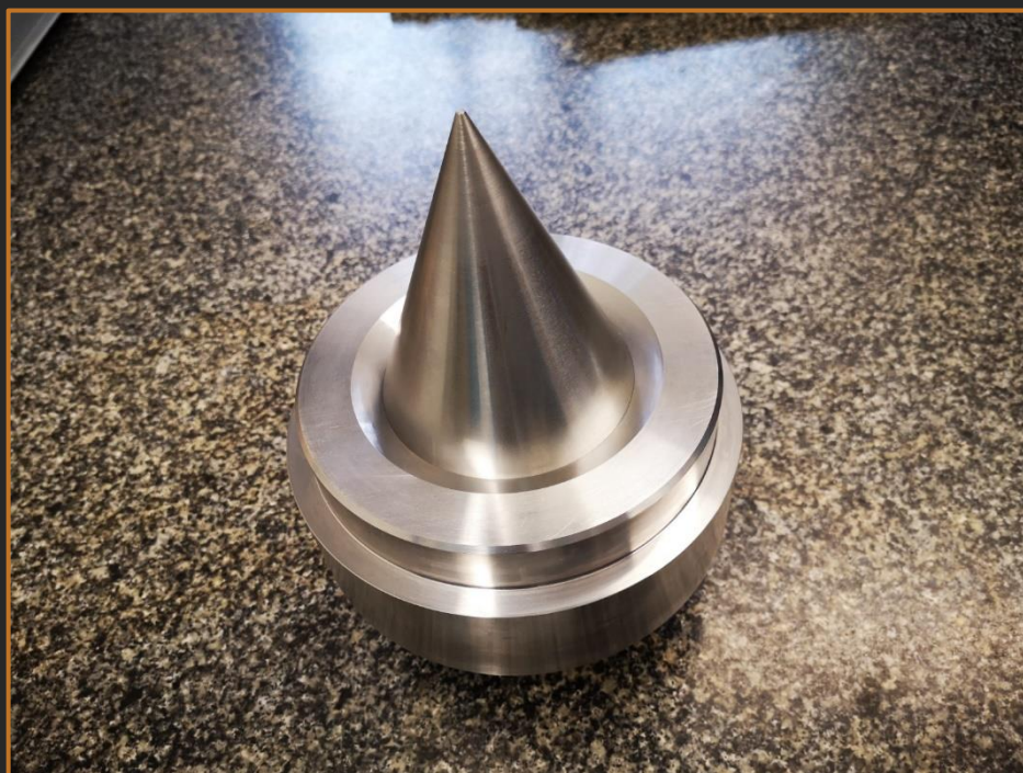
Pointeau injecteur + bec de buse (Z20C13)
