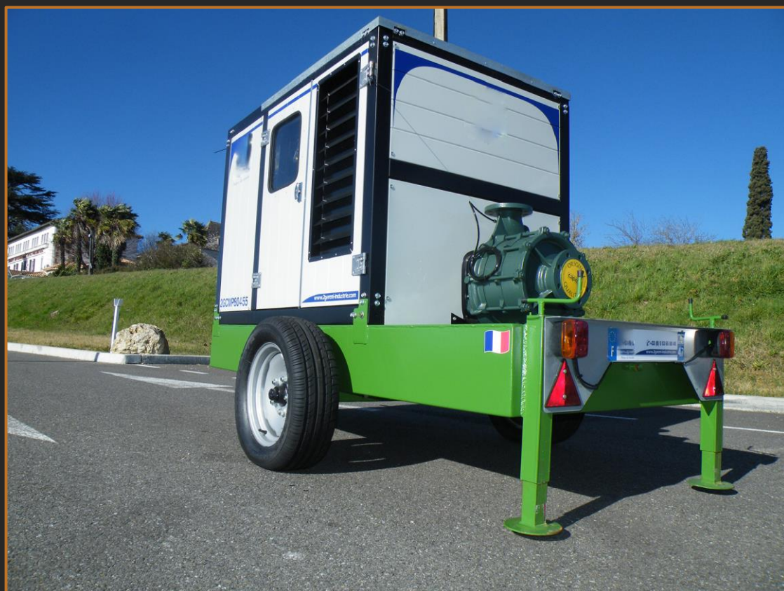
Châssis groupe motopompe / groupe électrogène
