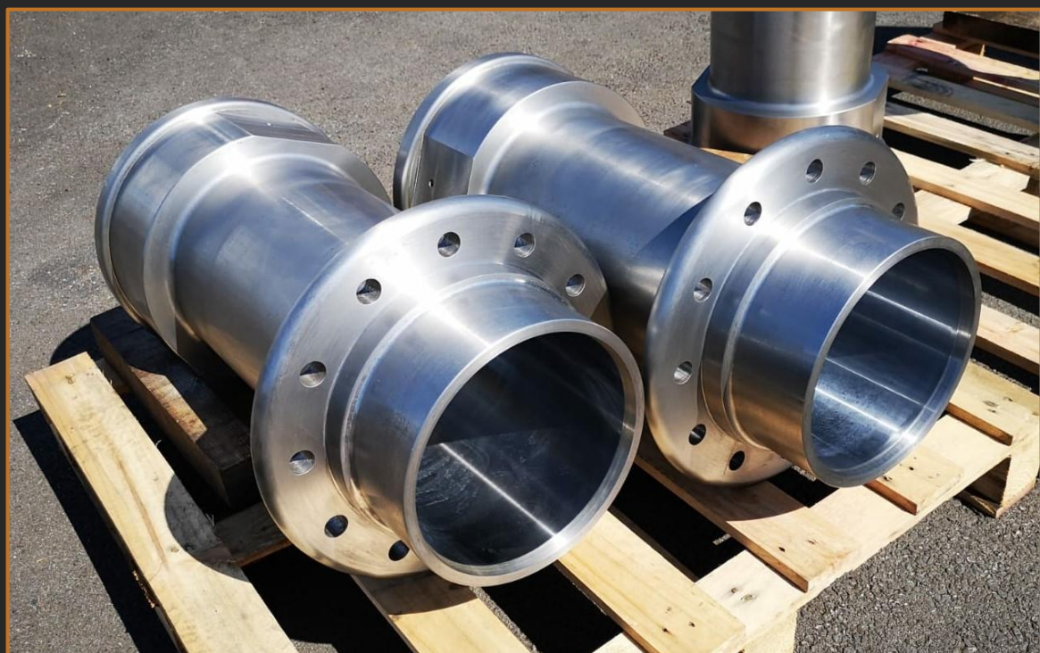
Corps cerveau moteur (taillé masse C45 + chromage alésage)
