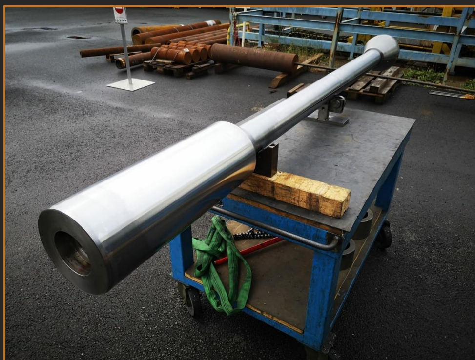
Pointeau injecteur + Tige de commande (Z20C13)
