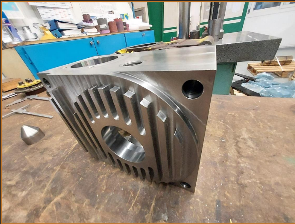
Boitier renvoi d'angle taillé masse sur mesure
