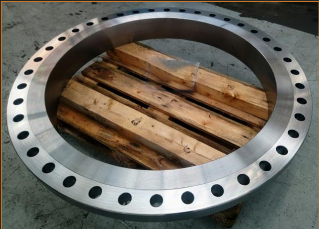
Anneau mobile vanne de pied (Z20C13)
