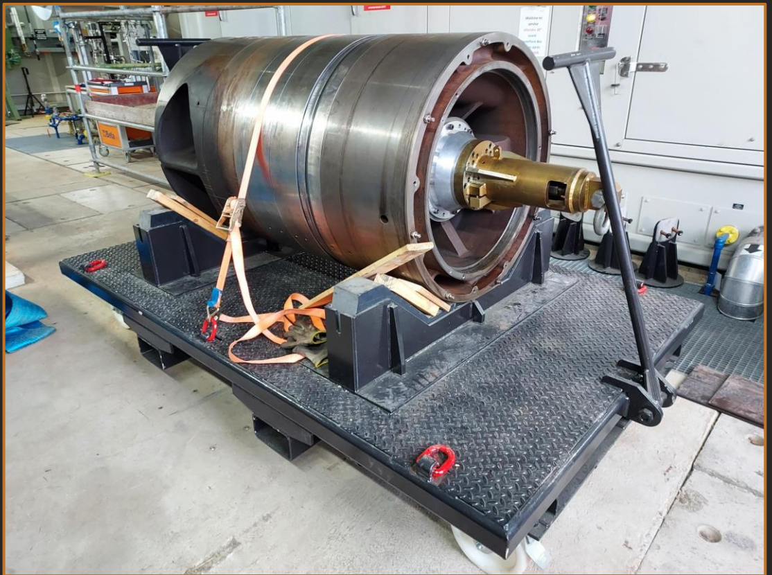
Chariot de transport pour bundle (CMU 8 tonnes)
