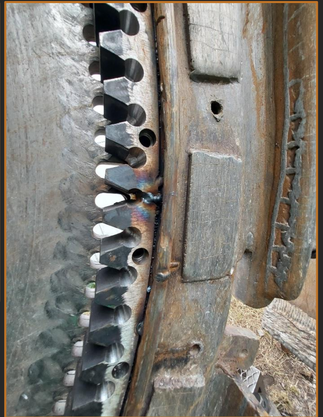
Réparation sur roue de trancheuse (30 tonnes)
