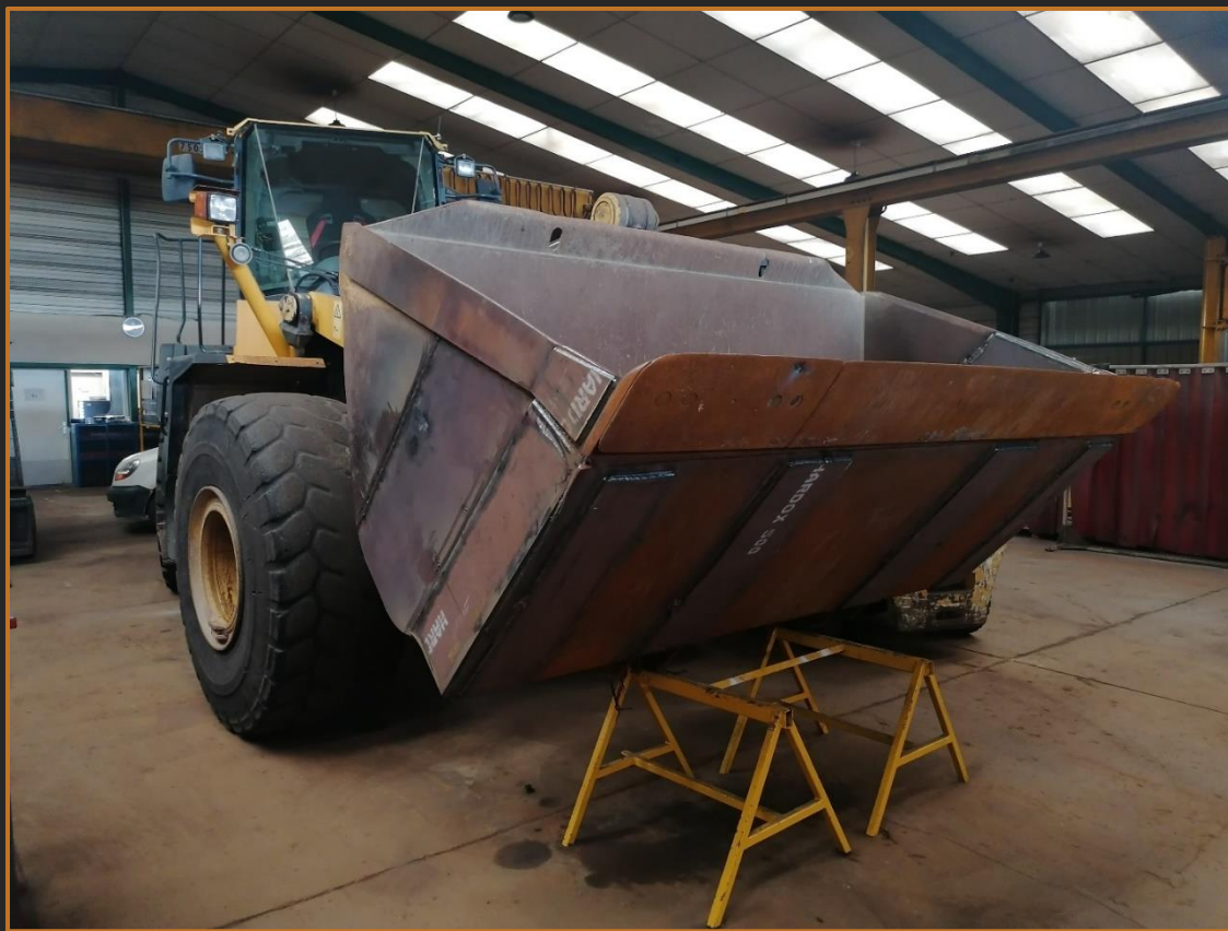
Réfection godet de reprise chargeur sur roue (5m 3 )
