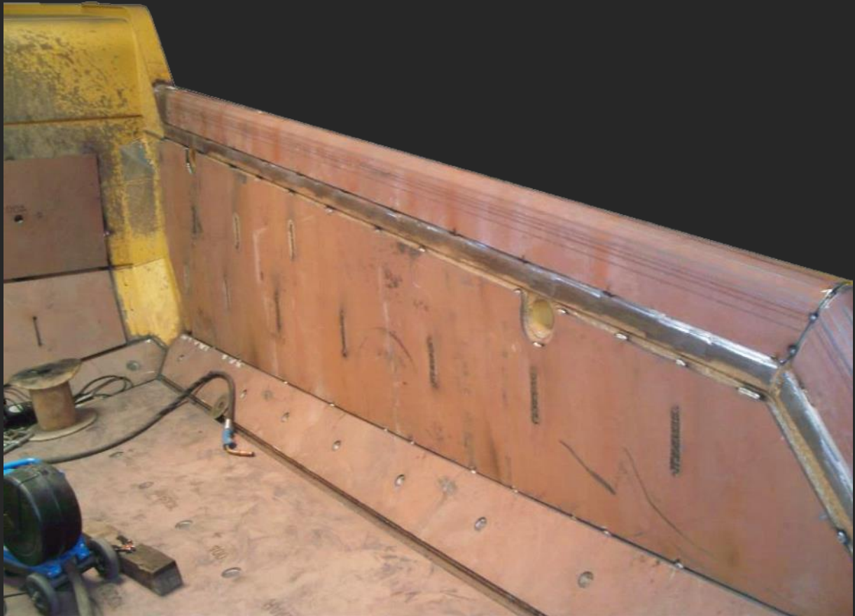
Reconditionnement : Benne de tombereau (Hardox 450)
