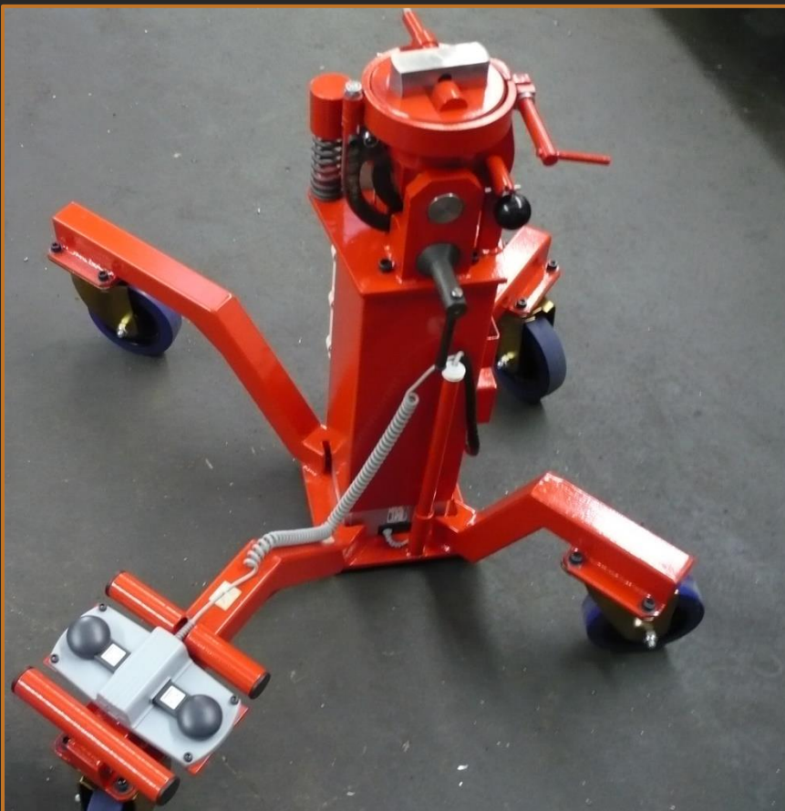
Positionneur d'arasage pièces aéronautiques
