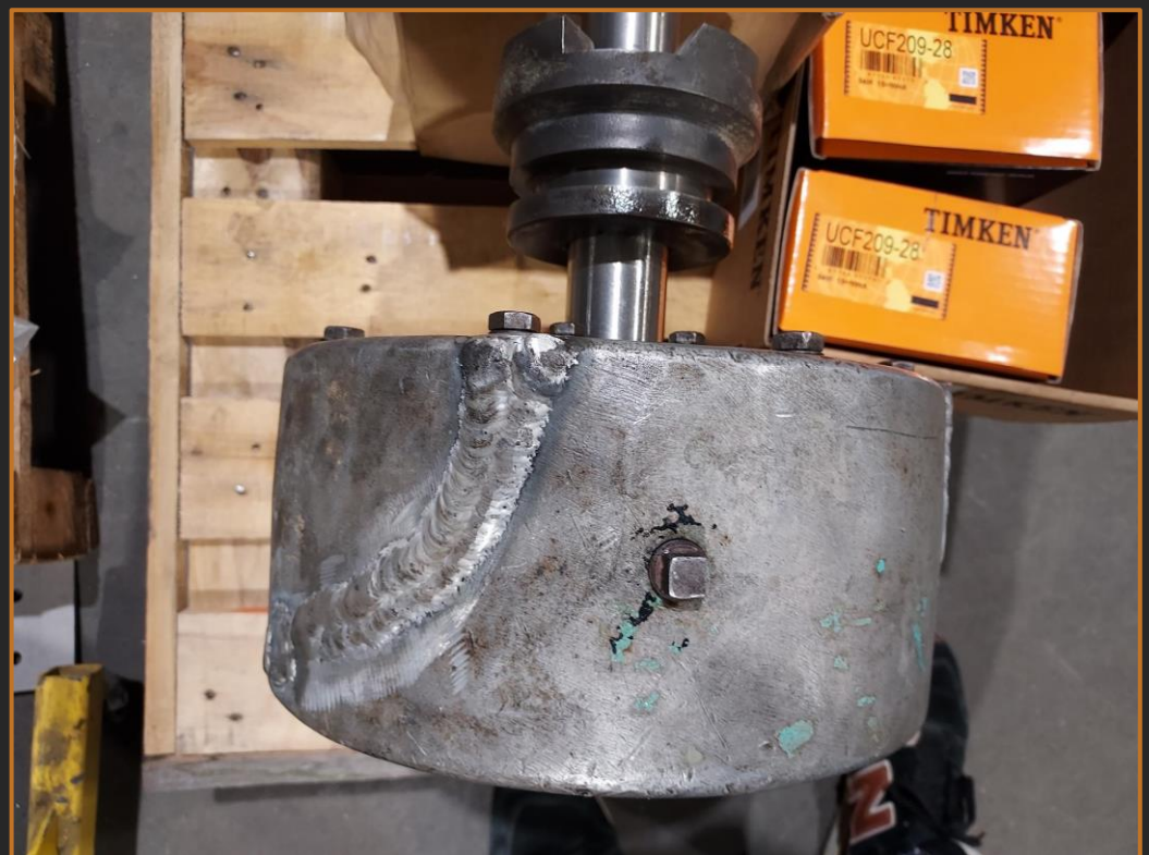
Remise en état renvoi d'angle mécanique
